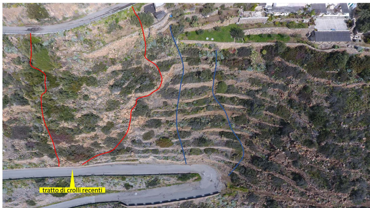
Figura 6 - Percorsi di corrivazione vecchi e nuovi ai piedi del rilievo Montagnola (da foto con drone marzo 2021)
