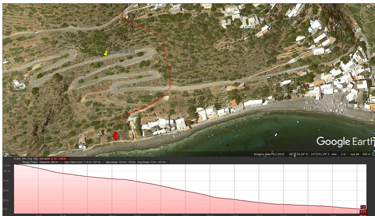
Figura 4 - Canale di scarico delle acque in un possibile stralcio funzionale (INTERVENTO B)
